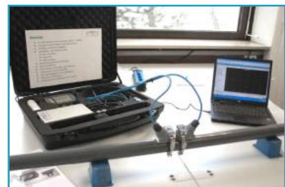
Workshop im Bereich Durchfluss, Clamp-On Ultraschallmessung
